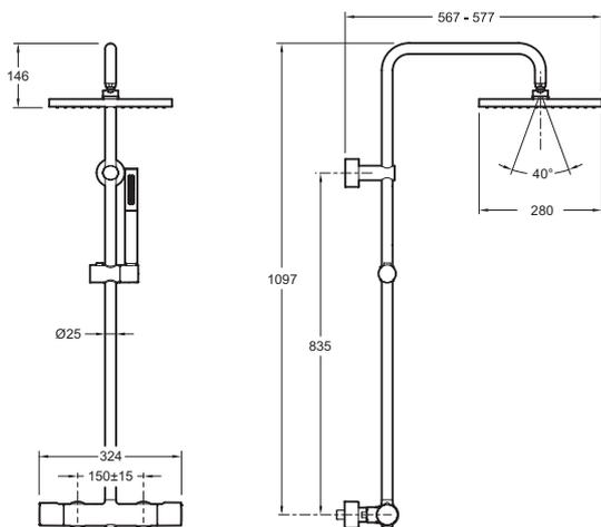
Спецификация продукта: Душевая колонна с термостатическим смесителем. E32850. Коллекция: BRIGITTE. ВЕС: 5,9 кг. МАТЕРИАЛ: Металл. ТИП УСТАНОВКИ: Крепление к стене.
